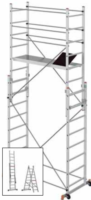
Andamio telescópico de aluminio 2 escaleras telescópicas que se transforman en andamio. Plataforma: 1,60x0,6 m. Base: 1,78x1 m. 2 ruedas frontales ø 100 mm. Capacidad máx. 150 kg. TARGETN
